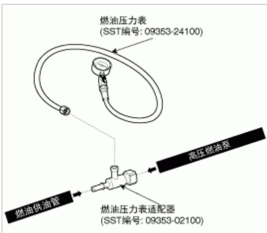
3. 点火开关置于ON位置，检查供油管、燃油总管和专用工具连接处是否漏油。
